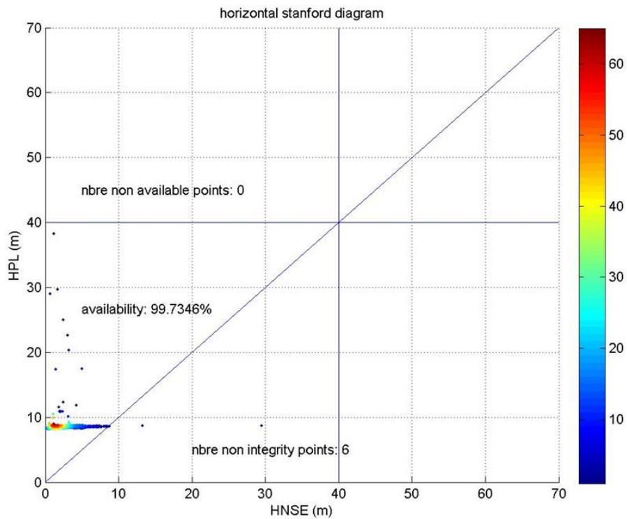
**Figure 35: Horizontal Stanford diagram**
